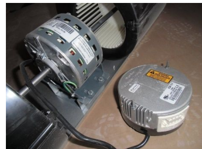
Motore EC e Filtro elettronico / EC motor and Electronic filter
